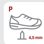
P Durchtrittshemmung Stahl (4,5 mm Nagel) Penetration Resistance Steel
